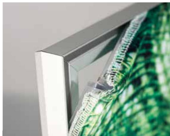
Un jonc PVC est cousu directement sur le pourtour du visuel textile et s'insère par simple pression dans la rainure du profilé Vector.
